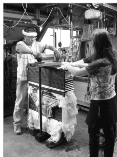
板を重ねボルトで締める
